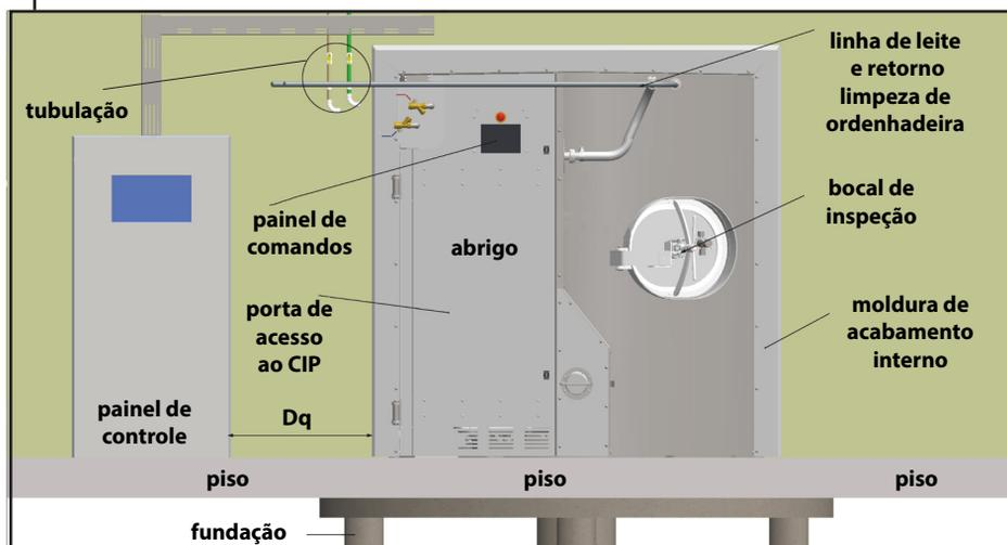
Fig. 1.2 - visão geral lado interno da instalação
